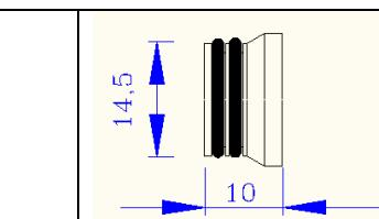
Адаптер применяется для присоединения к элементам трубопроводных систем, имеющим резьбовые патрубки с наружной резьбой стандарта «конус», соединителей с плоской прокладкой (например: гибкой подводки или фитингов VTm.222 16x1/2").
