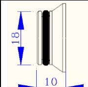
Адаптер применяется для присоединения к имеющим резьбовые патрубки с наружной резьбой стандарта «евроконус» соединителей с плоской прокладкой (например: гибкой подводки или фитингов VTm.222 16x3/4").
